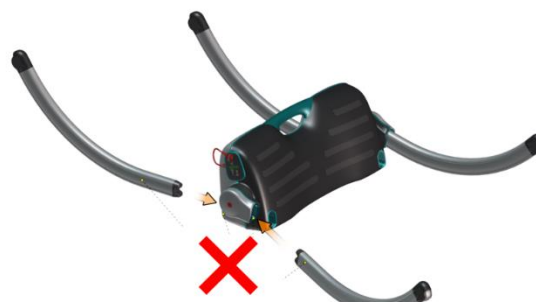
Assemblage incorrect (NE PAS monter les pieds en premier)
